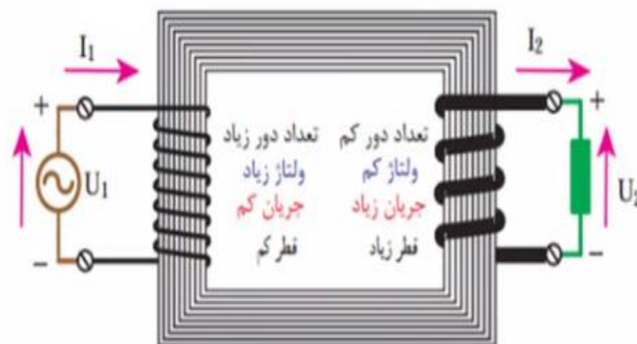
الف) ترانسفورماتور کاهش دهنده
