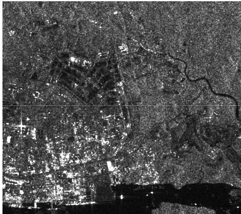
تصویر سنجنده ERS با سیستم تصویربرداری SAR و اندازه پیکسل ۵/۱۲ متری
