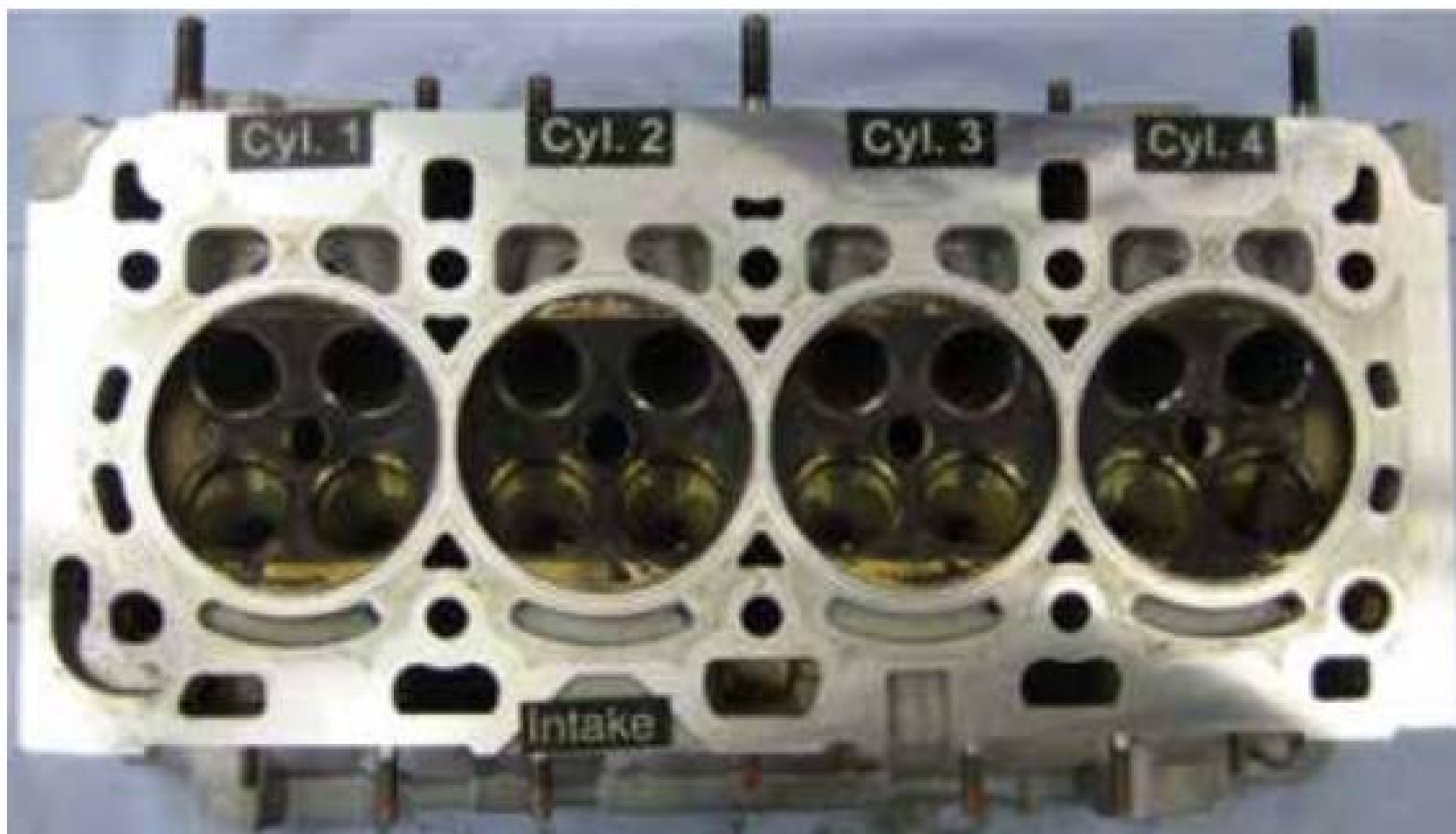
شکل ۳-۲- بدنه اصلی سرسیلندر یک موتور ۱۶ سوپاپ
