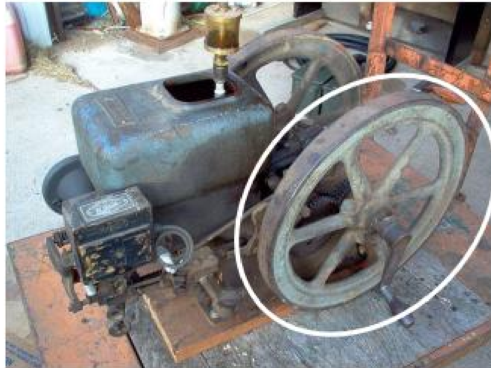
شکل ۸- تصویر فلاپیول موتور تک سیلندر (سمت راست) و یک فلاپیول موتور ۴ سیلندر (سمت چپ)
