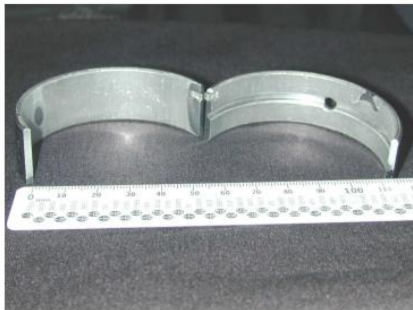
شکل-۷- یاتاقان های دو کپه ای ویژه لنگ های ثابت و متحرک میل لنگ
