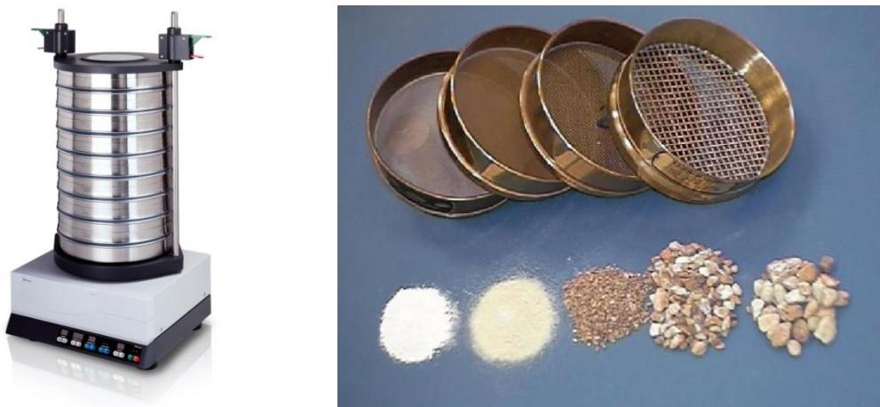
شکل ۱۱-۱ آزمایش دانه بندی مکانیکی با استفاده از سری الک
