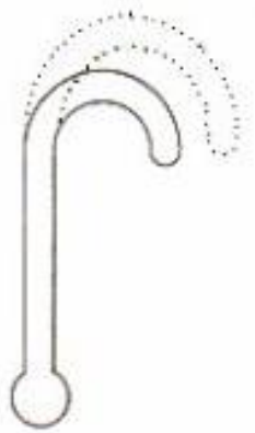
شکل (2-15): شکل کلی اندازه گیرهای دما از طریق فشار گاز
