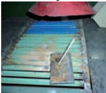
شکل ۴-۸b، الکتروود چسبیده به قطعه کار
