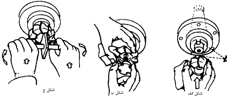
شکل ۱۸-۵ روش بستن تیغه فرزها
