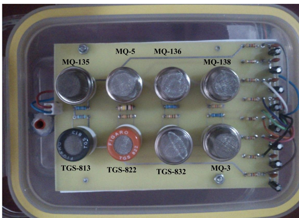
شکل ۳-۵: برد طراحی شده جهت آرایه حسگری بینی الکترونیکی به همراه چیدمان حسگرها.
