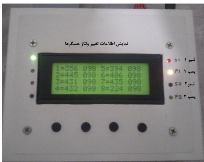
شکل ۳-۶: سیستم جمع آوری داده طراحی شده برای بینی الکترونیک.
