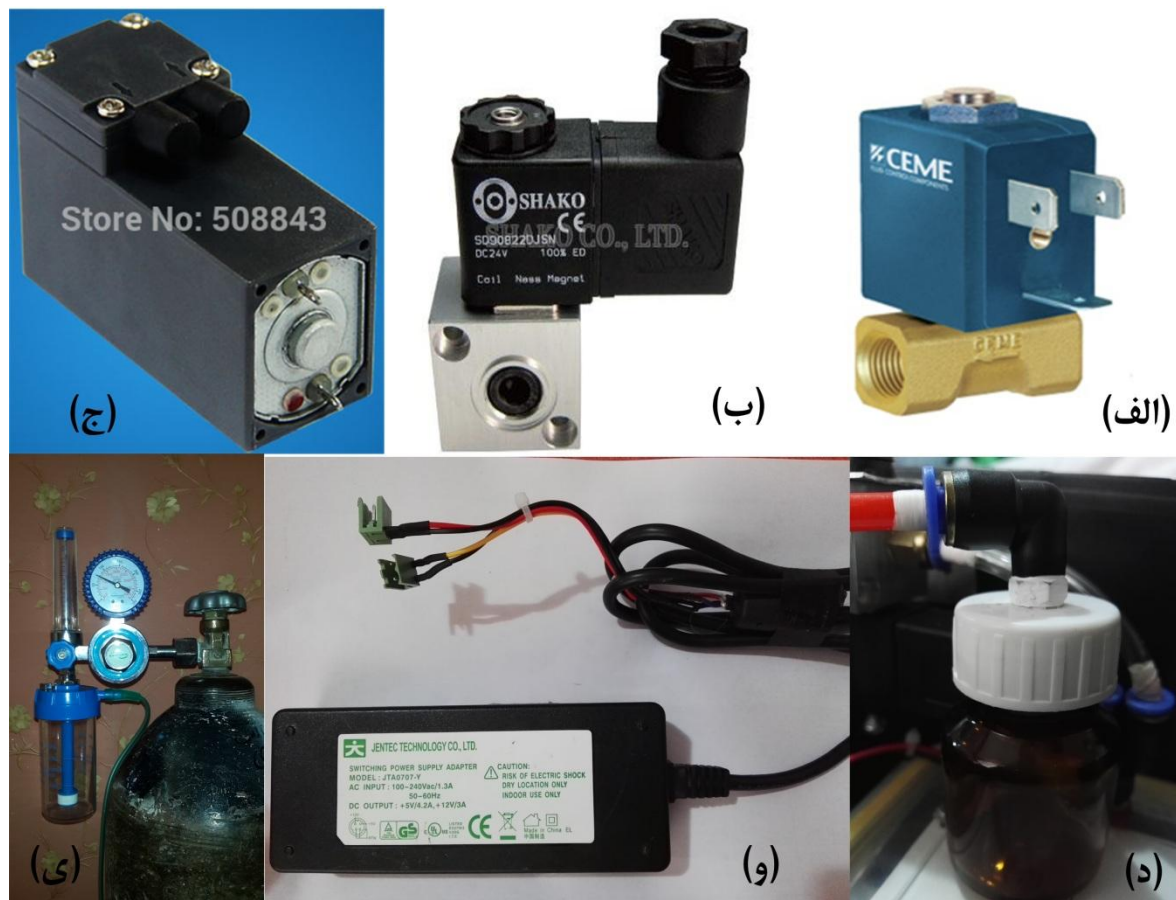
شکل ۳-۷: سایر اجزاء بینی الکترونیک: (الف) شیر برقی ۱ (Series 55, CEME, Italy); (ب) شیر برقی ۲ (SHAKO, Taiwan); (ج) میکرو پمپ (Guangdong, China); (د) محفظه نمونه; (و) منبع تغذیه ۱۲ و ۵ ولت; (ی) کپسول اکسیژن.
