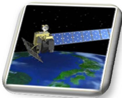
یکی از بزرگترین ماهواره‌های سنجش از دور که جهت مشاهدات زمینی با قدرت تفکیک زمینی ۱۰/۲ و ۵/۲ متر به صورت پوشش سراسری و استریو از کل زمین استفاده می‌گردد.
